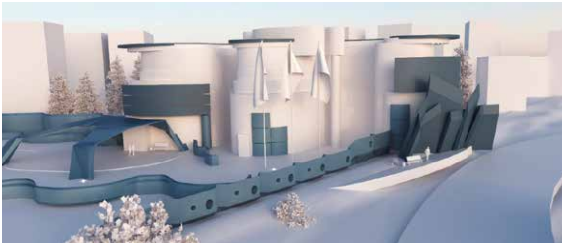
Abb. 1: 3D-gedruckte Stahlfaserbeton-Schutzbauteile am Beispiel eines Regierungsgebäudes (Quelle: eigene Visualisierung)
