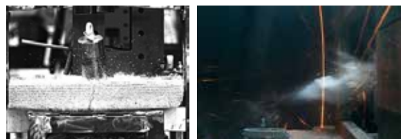
Abb. 4: Impaktierung der Probekörpervariante A durch den Fallkörper im Freifallversuch (links) und die Impaktierung durch ein Hartkerngeschoss im Beschussversuch (rechts)
