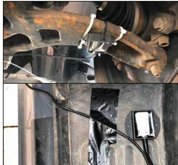
Abb. 2: Messaufbau mit zwei Beschleunigungssensoren
